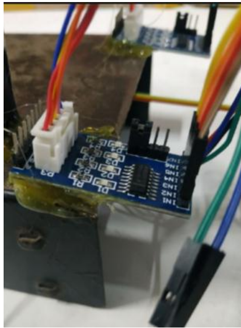
Figure 5-4 الشكل 4-5. تثبيت دارتي القيادة ULN2003.
