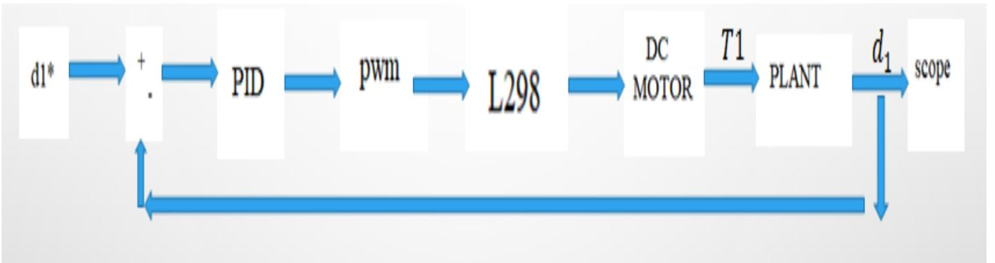
" $z=I$ " هي العطالة للمحرك و الحمل "مجموعهما" و " $B=b$ " هو ثابت التخماد الدوراني في المحرك والحمل تنسب إلى هيكل الثابت و " $C$ " هو ثابت المرونة الدوراني و  $K$  هو عامل الربح كما هو موضح بالشكل (49).
