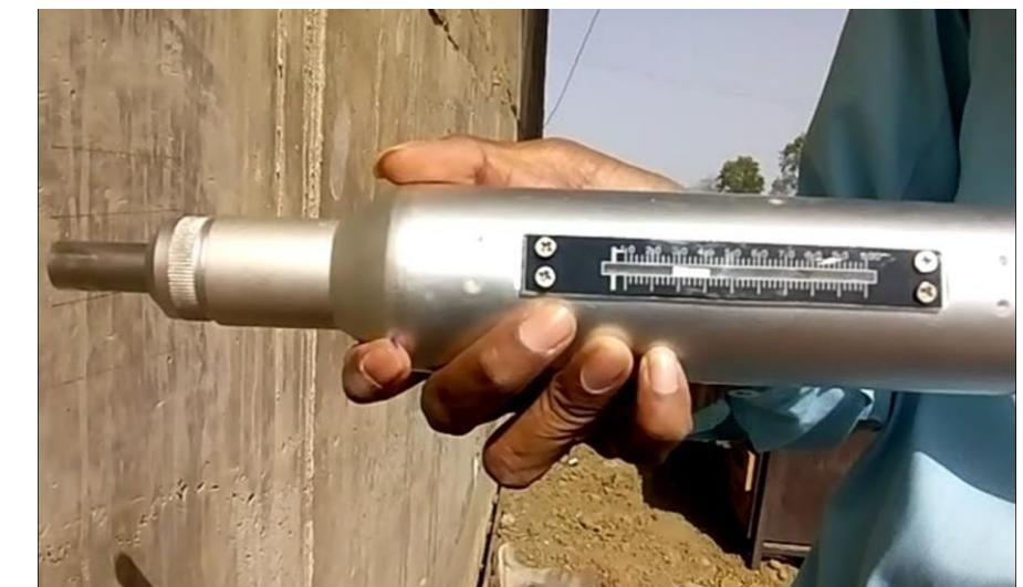
أجري على عمود خرساني اختبار مطربة شميدت وكانت المطربة أفقية، بعد الاختبار وجد أن رقم الارتداد  $R=30$
