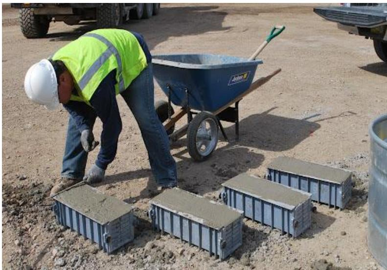
1. تجهيز القوالب (كمرات) بتجمیع أجزائها بإحكام ثم تدهن بطبقة رقيقة من الزيت لتفادي التصاق الخرسانة بالقالب أثناء الصب .
