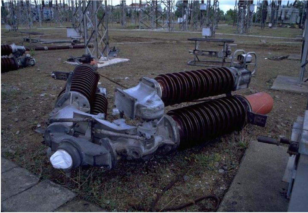
الشكل (4) تحطم قطب التوتر العالي لقاطع الاستطاعة.
