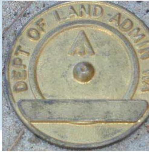
الشكل (2): النقطة المساحية النظامية مصنوعة من النحاس [وفقاً للنظام الأسترالي].
