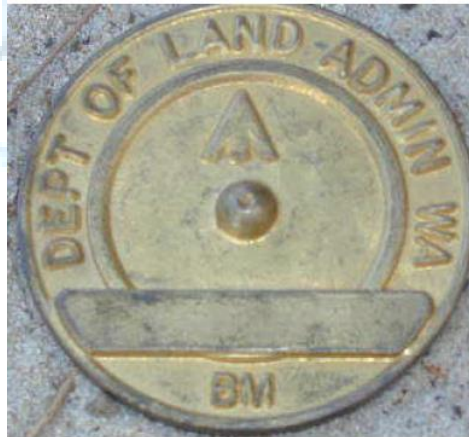
الشكل (5): نقطة BM مرجع تسوية نظامي مصنوع من النحاس [وفقاً للنظام الأسترالي].
