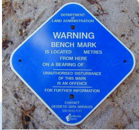
الشكل (4): لوحة وصف نقطة مرجع التسوية [وفقاً للنظام الأسترالي].
