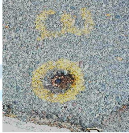
الشكل (9): وتد معدني مشار إليه باللون والدلالة الرقمية.
