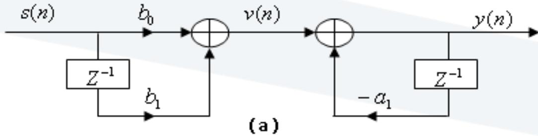
$$v(n) = b_0 \cdot s(n) + b_1 \cdot s(n-1) \quad \text{الشكل المباشر (a):}$$
