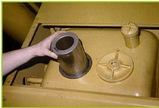
الشكل (3) مرشح الزيت ومبدأ عمله
