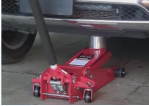
الشكل (4) مبدأ رافعة السيارة الهيدروليكية
