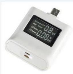
و هو جهاز ديجيتال الكتروني يعمل على إعطاء تراكيز الكحول الموجودة في الدم مباشرة. مبدئاً: الكحول يتم أكسدته إلى حمض الاستيك مولد تيار كهربائي (الكترونيين لكل جزيئة ايتانول) يتاسب شدته مع تراكيز الايتانول. و من ثم يختبر حمض الاستيك إلى اوكسجين  $\text{O}_2$  و ماء. يستمر القياس 20 ثانية.
