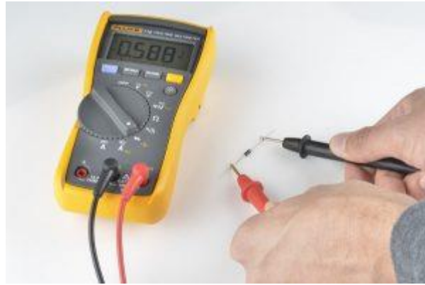
استخدام الأفومتر لقياس فرق الجهد الأمامي عبر الديود.
