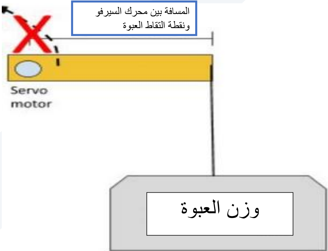
الشكل (١٨) تمثيل لعملية دوران محرك السيرفو
