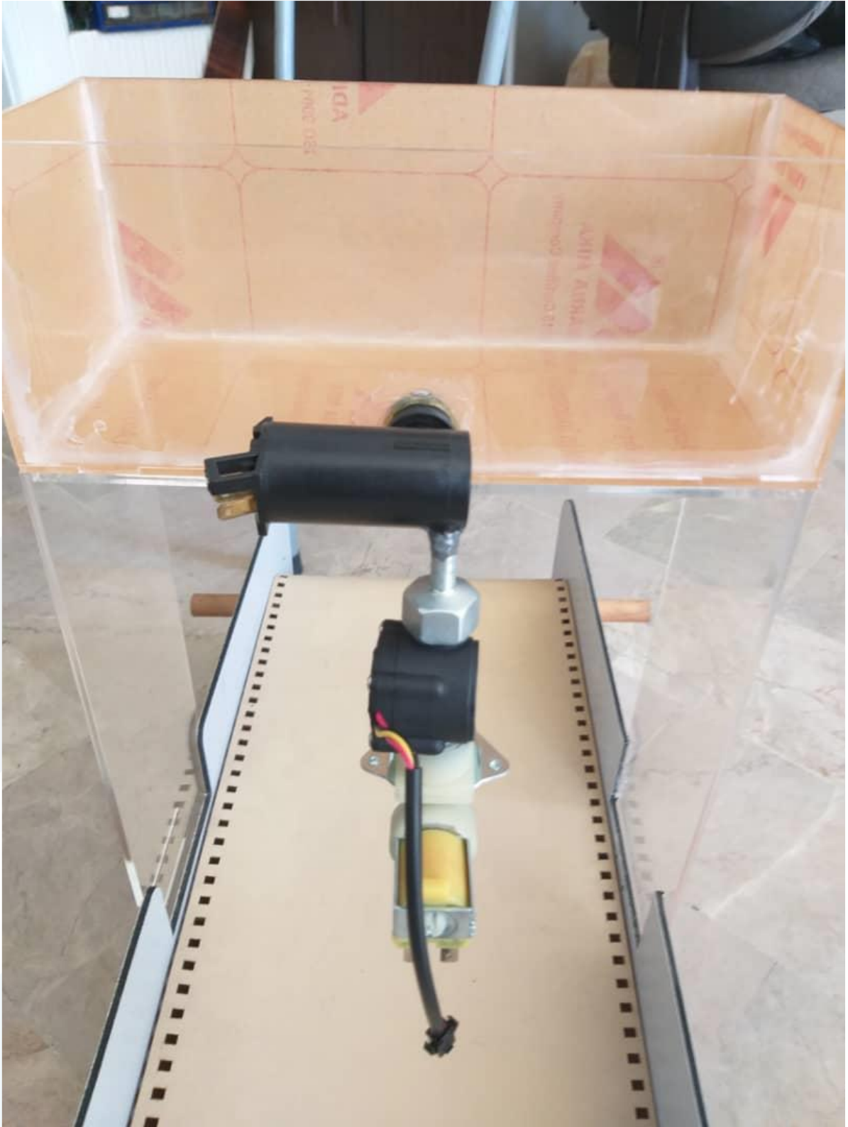
الشكل (٨) توصيل المضخة وحساس التدفق والصمام بالخرزان
