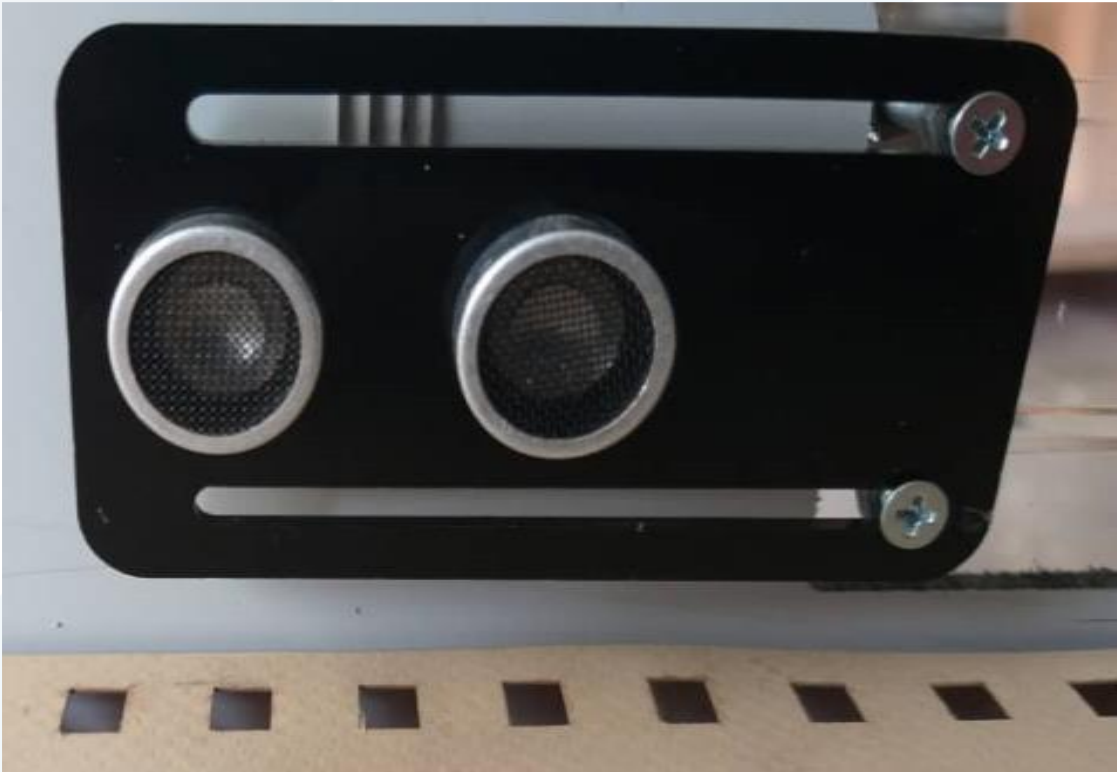
الشكل (١٠) قاعدة حساس ultrasonic وتثبيتها على جدار الخط تحت الخزان
