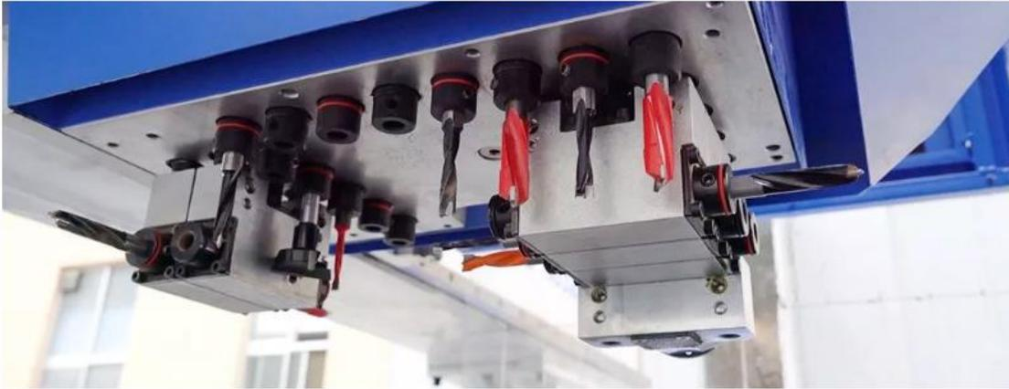
الشكل 4. جهاز التوجيه ATC CNC.
