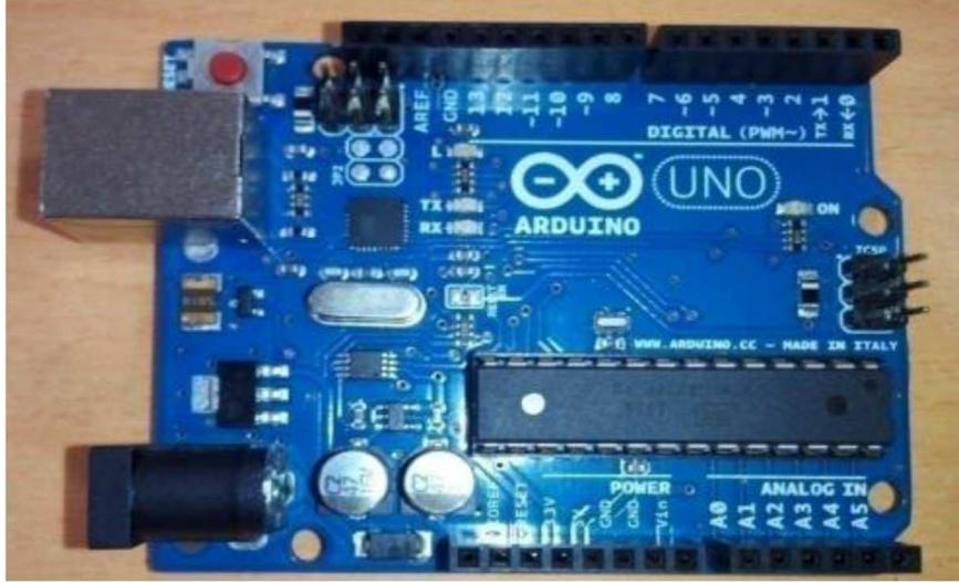
الشكل 15. لوحة Arduino Uno.
