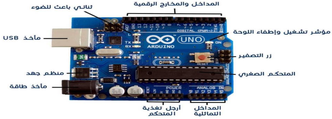
الشكل 17 مكونات لوحة الأردوينو أونو.
