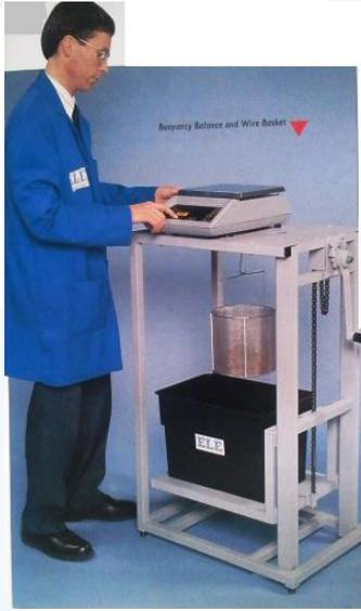
تابع للشكل (16-1): اختبار الكثافة المطلقة للمواد
