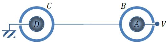
تتأصل مكثفة كروية، عازلها الهواء، ونصف قطرها لبوسيها  $R_1$  و  $R_2$  (حيث  $R_1 < R_2$ ) ، بمكثفة ثانية مائلة بحيث
