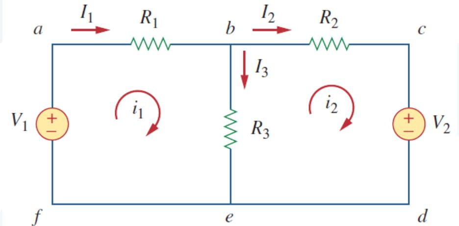
$$\begin{bmatrix} R_1 + R_3 & -R_3 \\ -R_3 & R_2 + R_3 \end{bmatrix} \begin{bmatrix} i_1 \\ i_2 \end{bmatrix} = \begin{bmatrix} V_1 \\ -V_2 \end{bmatrix}$$
