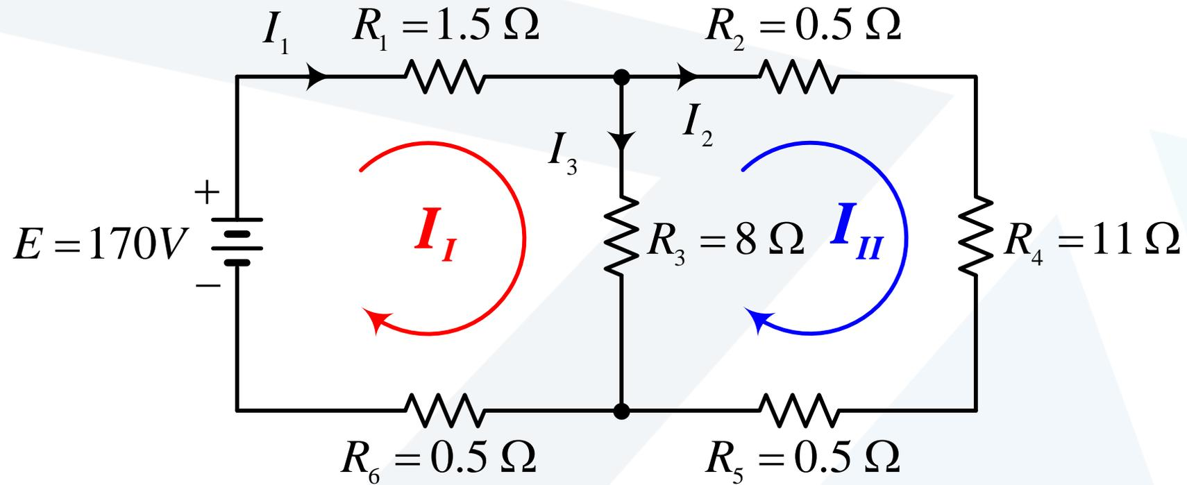
$$E = I_I \cdot (R_1 + R_3 + R_6) - I_{II} \cdot R_3$$
