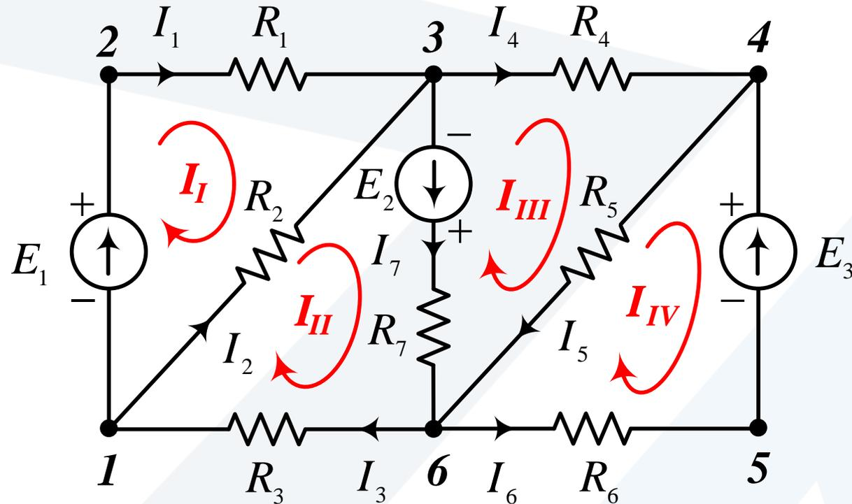
التيار الفعلي المار في المقاومة  $R_1$  هو قيمة التيار الحلقي  $I_I$  نفسه، أي:  $I_1 = I_I$
