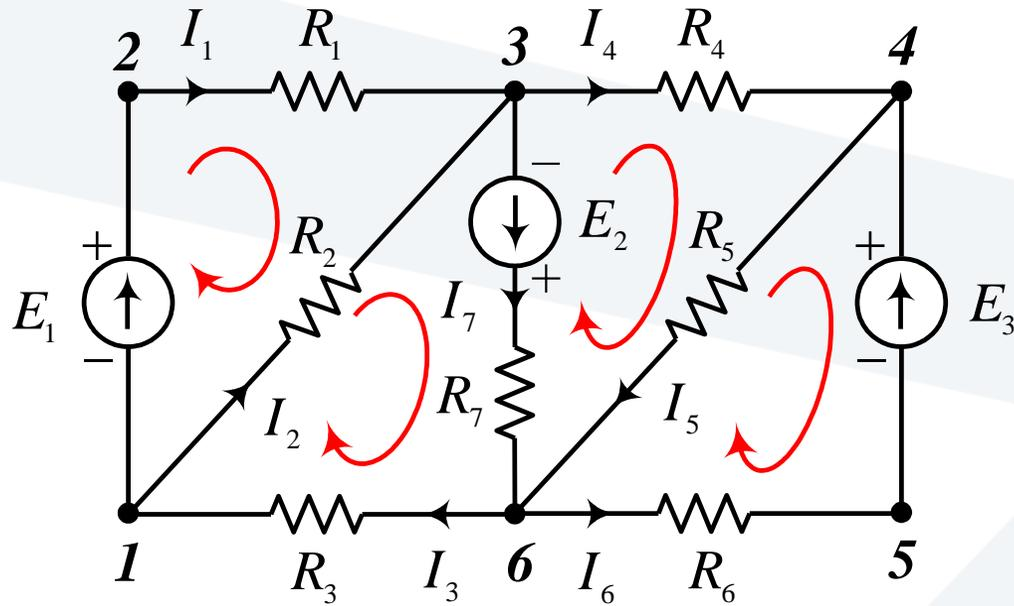
$$E_1 = I_1 \cdot R_1 - I_2 \cdot R_2 \quad \text{في الحلقة 1-2-3-1}$$
