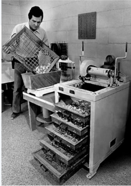
الشكل (6-1): تجربة التحليل الحبي للحصويات الخشنة
