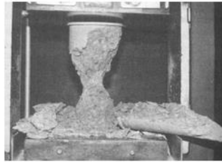
الشكل (2-2): أنماط انهيار عينة بيتونية على الضغط البسيط
