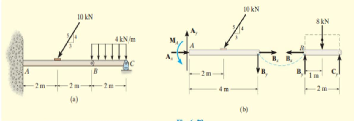
1- مخطط الجسم الحر: من أجل مخطط الجسم الحر لكامل الهيكل نلاحظ وجود ثلاثة مجاهيل عند التثبيت التام A، ومجهول واحد عند الذراع المتأرجح C، وبالتالي عدد المجاهيل أكبر من عدد المعادلات .، نفصل الهيكل عند المفصل B ونرسم مخطط الجسم الحر لكل جزء .
