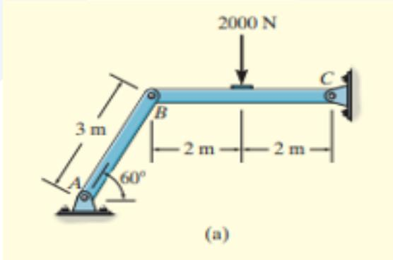
**الحل:** ننظر إلى كامل الهيكل ونعد المجاهيل : لدينا نقطتي استناد ذات وصلات مفصلية (Pin connected) عند A و C وبالتالي لدينا أربعة مجاهيل ، إذاً نفصل الهيكل عند B ، مع ملاحظة وجود عنصر TWO FORCES MEMBER وهو العنصر AB.
