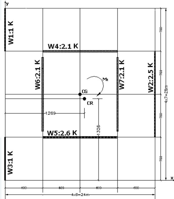
بالتالي، يمكن تحديد عزم الفتل الناتج عن القوة الزلزالية بالاتجاه  $y$ ، بعد اعتماد لامركزية طائفة مقدارها 0.05 من بعد المسقط في الاتجاه  $x$  (حتى لو كانت المنشأة متناظرة).
