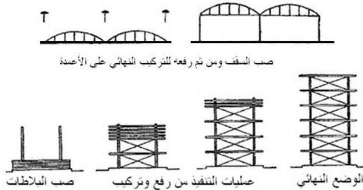
الشكل (47-1): تنفيذ عناصر أسقف صالة مسبقة الصنع (طابق واحد أو متعدد الطوابق)
