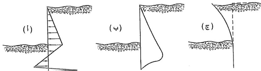
الشكل (1-32): انهيار انعطافي لجدار ظفري
