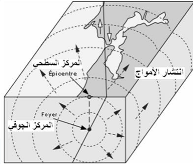
الشكل (2-65): المركز الجوفي والسطحي للزلزال - طول الفالق المتصدع - انتشار الأمواج الزلزالية
