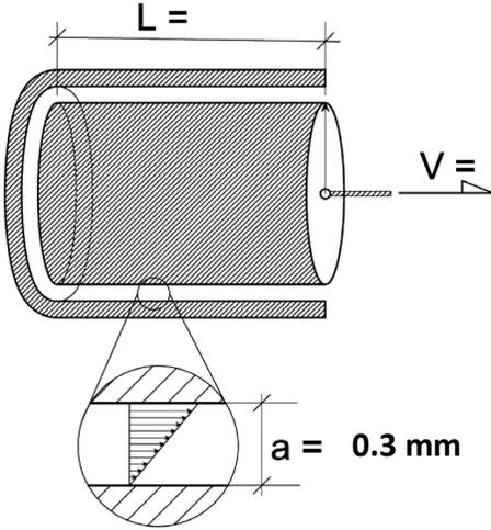
لدينا أسطوانة مكبس قطرها  $D = 12 \text{ cm}$  وطولها  $L = 30 \text{ cm}$  تتحرك حركة انسحابية ضمن قميص أسطواني يزيد قطره الداخلي عن قطر الأسطوانة بمقدار  $0.3 \text{ mm}$  حيث يملأ الفراغ بين الأسطوانة المتحركة والقميص بزيت لزوجه الديناميكية  $\mu = 5.4 \text{ poise}$
