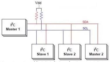
الخطان من نوع "تصريف مفتوح" open drain مما يعني أنه يجب إيصالهما بمقاومات لأعلى pull up resistors بحيث تكون الخطوط مرتفعة high، وهي الحالة الغير نشطة ldle للناقل bus بينما عندما تكون الأجهزة على هذا الناقل نشطة تكون الخطوط منخفضة low. وللإيضاح أكثر، فإن الخطوط من هذا النوع تكون الأطراف المتصله بها غير متصلة بشكل مباشر بمصدر الطاقة VCC وإنما تتصل مباشرة بـ GND.
