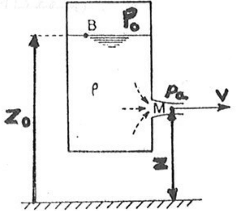
— Réservoir de liquide sous pression.
