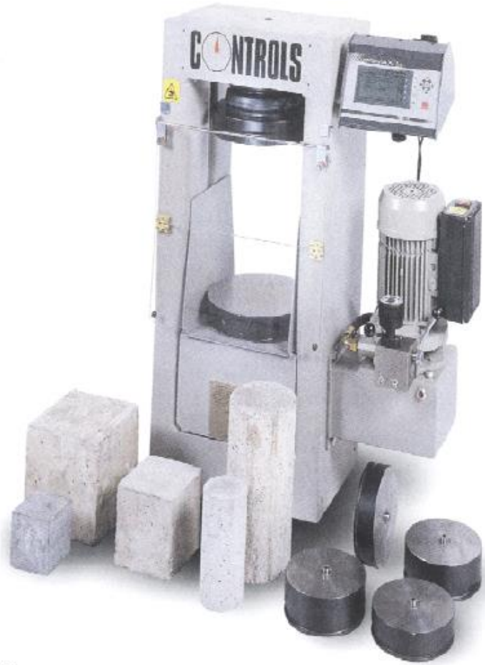
ماكينة الضغط وعينات الاختبار
