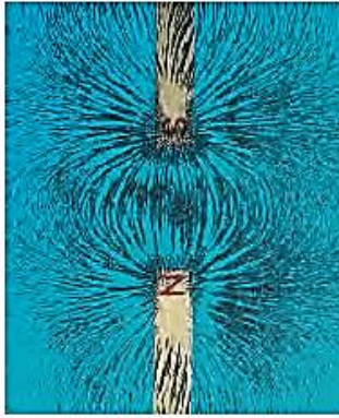
(a) نموذج لحقل مغناطيسي ناتج عن قضيب مغناطيسي مغطى بكمية صغيرة من برادة الحديد على صحيفة من الورق، (b) نموذج لحقل مغناطيسي بين قطبين مختلفين لقضيبين مغناطيسيين، (c) نموذج لحقل مغناطيسي بين قطبين متماثلين.
