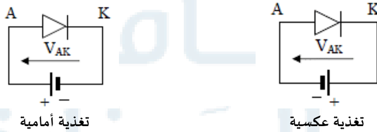
شكل (4): تغذية أمامية وعكسية للديود أو للمتصل ثنائي.
