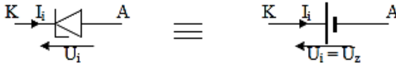
شكل (13): مخطط مكافئ لـ ديود زينري مثالي بتغذية عكسية.
