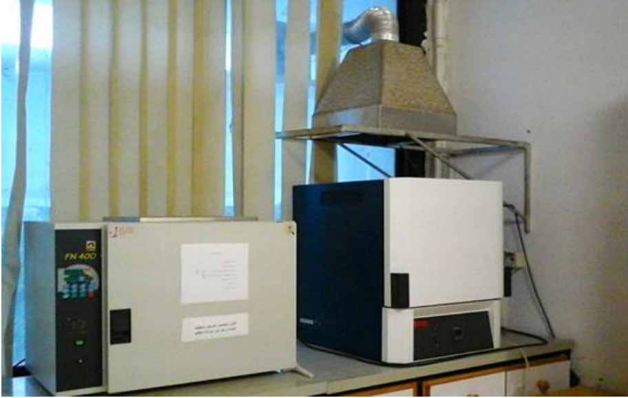
الفرن الكهربائي والمرمدة لقياس نسبة المادة العضوية.
