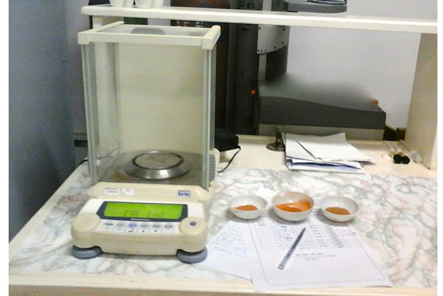
حساب الفاقد بالوزن لنسبة المادة العضوية قبل وبعد الترميد.
