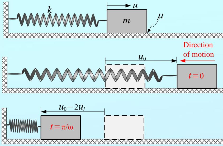
$$u(t) = A \cos(\omega t) + B \sin(\omega t) - (\text{sign}(u_l)) u_l$$
