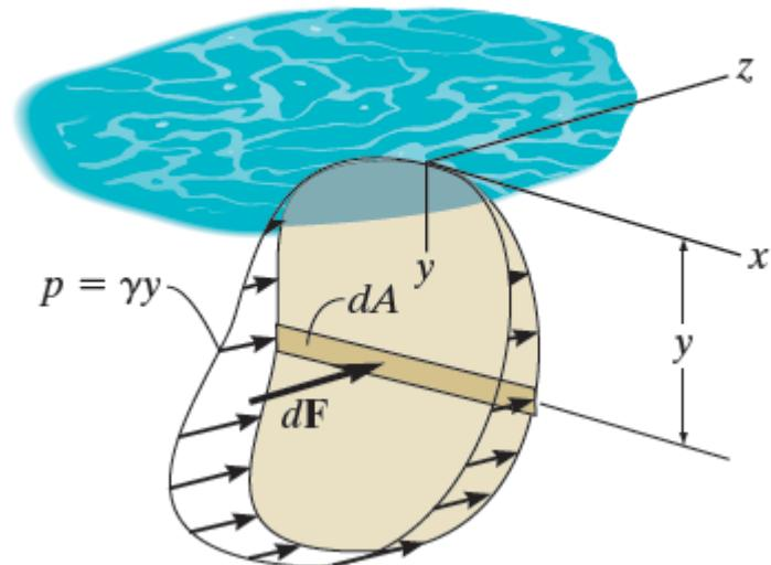
مثلاً من أجل الصفيحة المبينة في الشكل المغمورة بالسائل تخضع لضغط  $P$  الضغط يتغير خطياً مع العمق يساوي  $y$  حيث  $P = \gamma y$  حيث  $\gamma$  الوزن الحجمي للسائل
