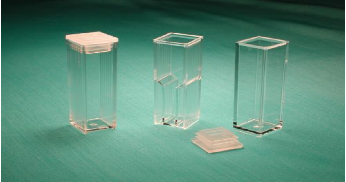
الشكل ( ٩-٤ ) : خلايا القياس المستخدمة في طريقة التحليل الطيفي الضوئي .
