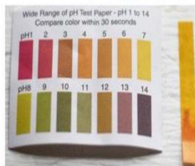
2. طريقة (Test strip) ← وهي طريقة غير دقيقة.
