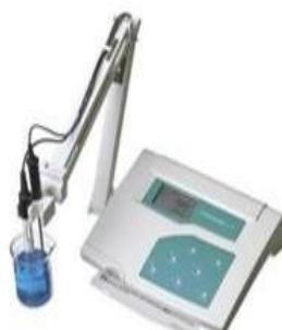
1. باستخدام جهاز جهاز خاص يسمى pH meter ← وهي طريقة دقيقة لقياس الرقم الهيدروجيني للمحاليل.
